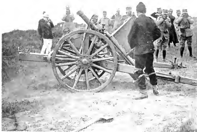
CANNONE DA CAMPANIA, DI O. DE PORI, DA 75 MM., A TIRO RAPIDO.
