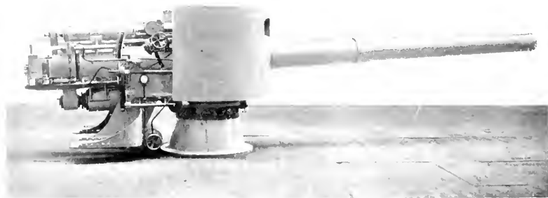
CANNONE PER UN IDRO-AEROMOBILE, DA 152 MM., A TIRO RAPIDO, SU AFFUSTO A PIEDISTALLO CON SCUDO, PER NAVI E PER FORTI ZEE.
