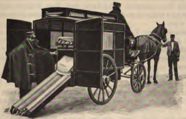
Krankenwagen der Ambulance Stations des Metropolitan Asylums Board in London für zwei liegende Kranke. Omnibusform (hinten geöffnet).
