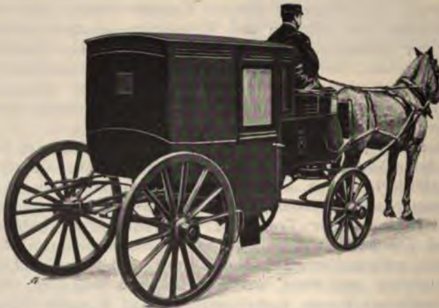
Krankswagen der Ambulance Stations des Metropolitan Asylums Board in London (Coupéform, geschlossen.)
