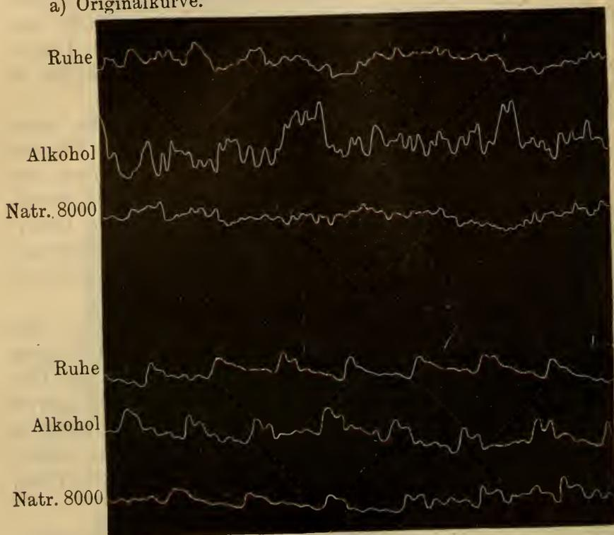
Da zur Abnahme der Fusspendelkurve die gewöhnliche Pelotte des Sphygmographen sich nicht eignete, so verwandte ich einen der bekannten Spritzflaschenballons, dessen Kautschukrohr ich mit der Schreibfederpelotte verband. Der Ballon wurde an einem schweren Stativ sicher befestigt und dann gegen die Fussspitze der Person so angerückt, dass die Pendelungen voll sich übertrugen; gleichzeitig wurde die Spitze des freigehaltenen Armes auf die Pelotte der zweiten Schreibfeder gesetzt.
