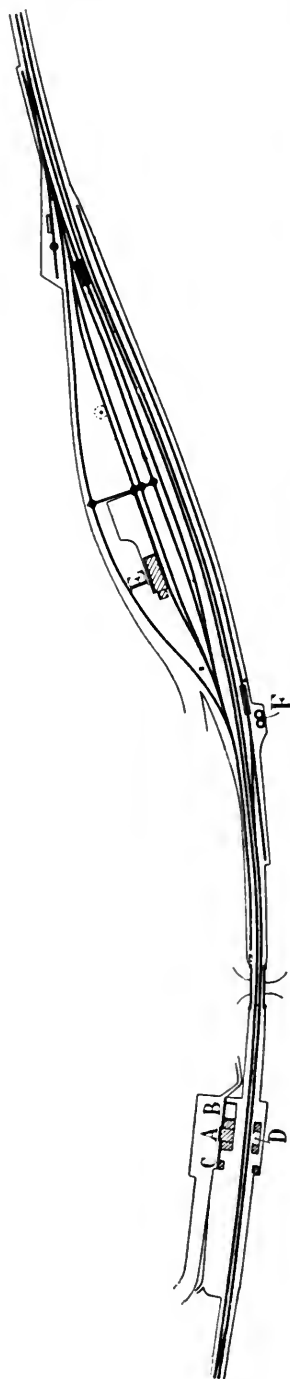
FIG. 23. — Groupement des voies en faisceaux.
