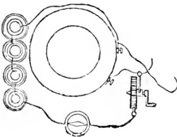
dei poli della pila, e l'altro polo è in contatto con un filo il quale, dopo essersi avvolto spiralmemente su di un cilindro di ferro dolce comunica con una lastra metallica fissa, la quale viene urtata successivamente dai denti della ruota.
