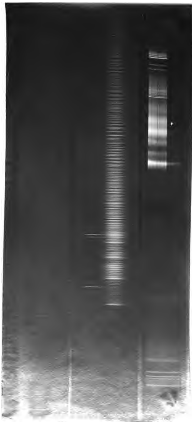
Oben Kohlebande 5165, Mitte Fortsetzung derselben und Bande 4737 unter 16 Atmosphären Druck. Unten links Baryumchlorid in der Bogenflamme; rechts Borbanden in der Kohlebogenflamme, darunter Bor in Leuchtgasauerstoffflamme.
