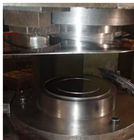
شكل 68 المكبس بعد الكبس
