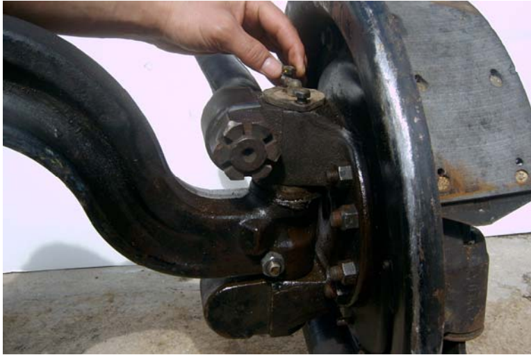
الشكل (2- 19) يبين فك غطاء الشحم عن طريق فك المسامير الخاصة به
