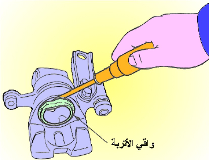
الشكل (5- 43) يبين فك واقى الأتربة من المكبس
