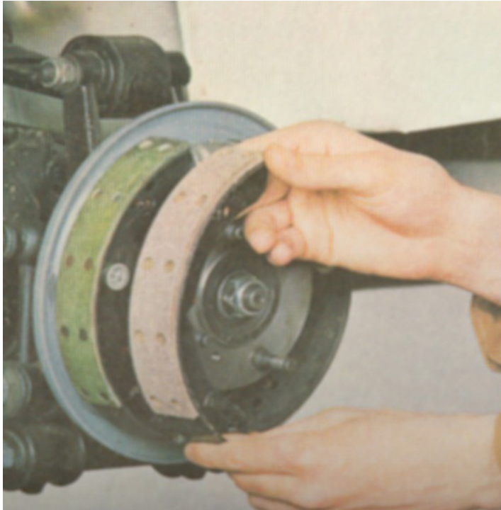
الشكل (5- 49) يبين مطابقة القماشات القديمة الموجودة على المركبة مع القماشات الجديدة
