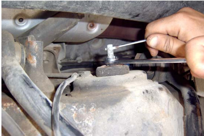
الشكل (2- 26) يبين طريقة فك مانع الارتجاج " المساعد " عن طريق فك المسمار العلوي
