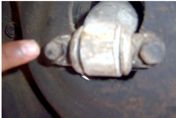
الشكل (2- 27) يبين مسمار مانع الارتجاج " المساعد " السفلي
