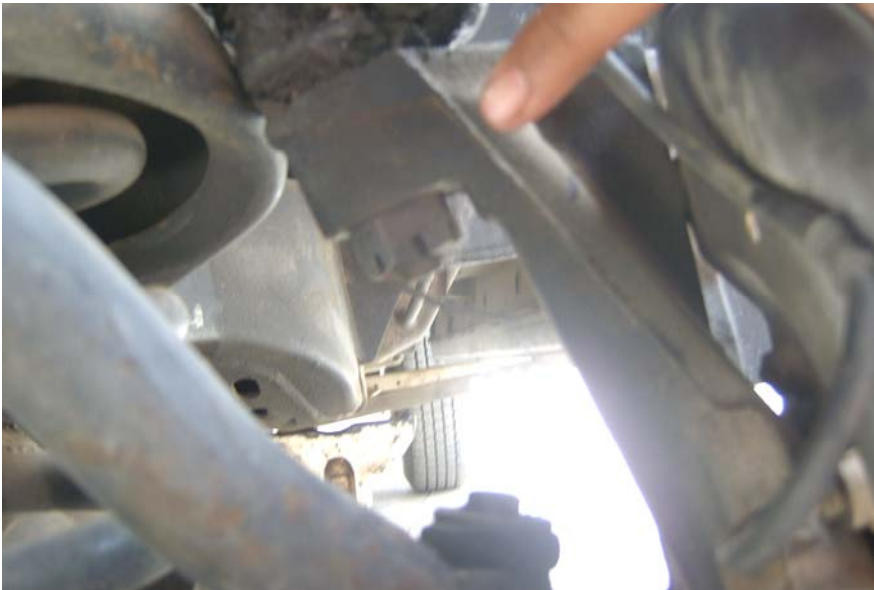
الشكل (2- 29) يبين مكان المسمار الكروي العلوي(الركبة)
