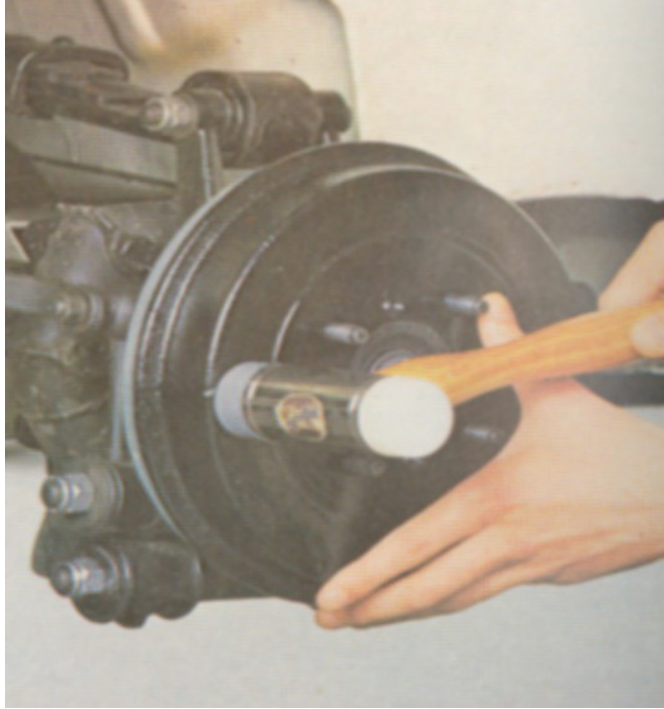
الشكل (5- 48) يبين طريقة الضرب على الهوب بواسطة مطرقة بلاستيكية
