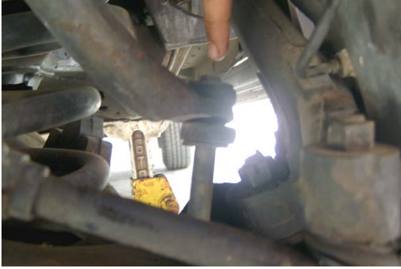
الشكل (2- 30) مكان مسمار عمود التوازن
