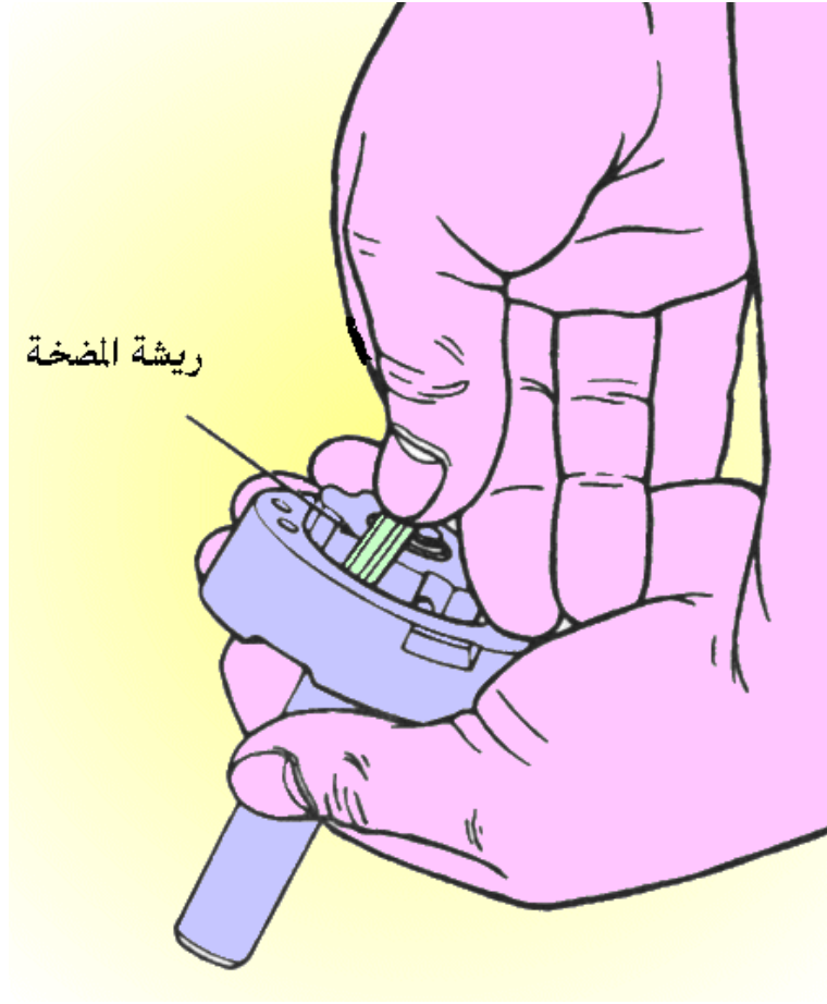
الشكل (3- 32) يبين إدخال الريش داخل دوار المضخة
