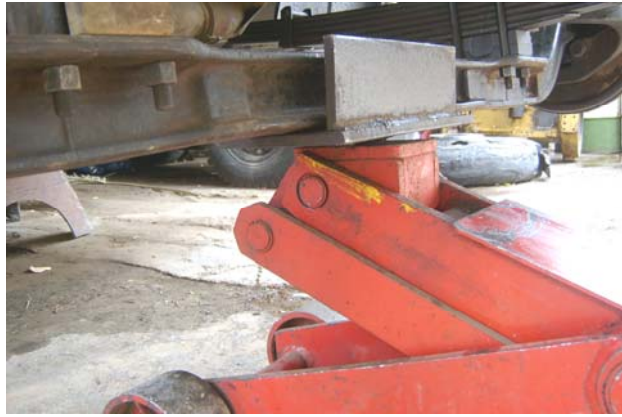
الشكل(2- 23) يبين رفع المحور بواسطة الرافعة
