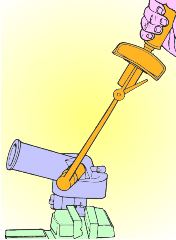
الشكل (3- 37) يبين الشد على المضخة بواسطة مفتاح العزم
