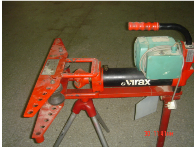
ثناية مواسير كهربائية (شكل 7 - 7)
