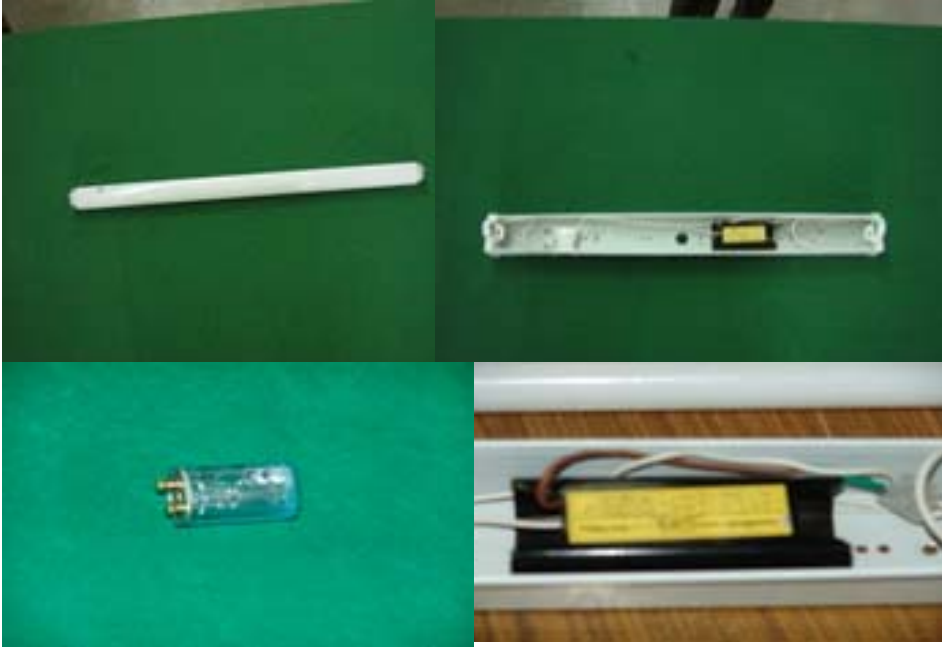
لمبة فلوريسنت مكونة من الغلاف اللمبة والملف الخائق وبادئ الإضاءة
