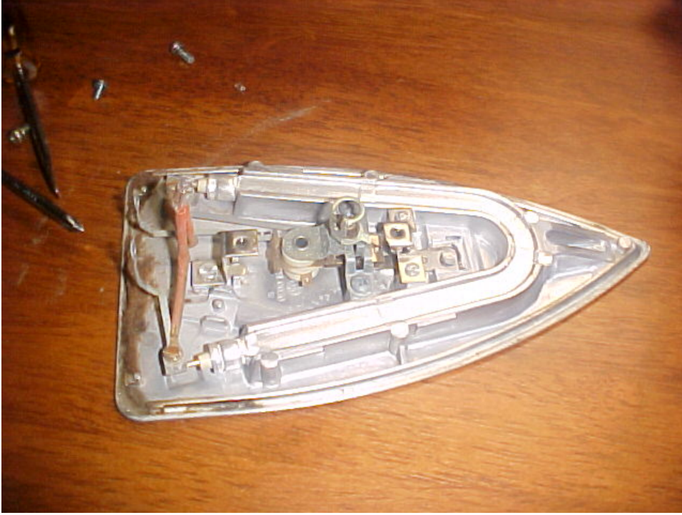
مفتاح التحكم بدرجة الحرارة من الداخل
