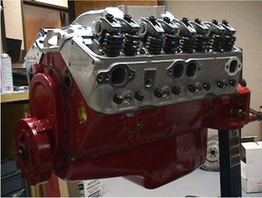
الشكل (2 - 15) يبين وضع المحرك على الحامل الخاص به القابل للحركة
