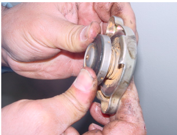
الشكل (1 - 28) يبين غطاء المشع أثناء فتح صمام الضغط لتصريف الضغط الزائد في الدائرة
