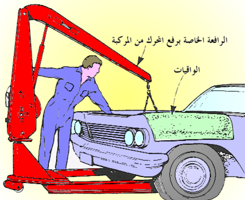
الشكل (13_2) يبين طريقة تثبيت الرافعة الهيدروليكية الخاصة برافع المحرك
