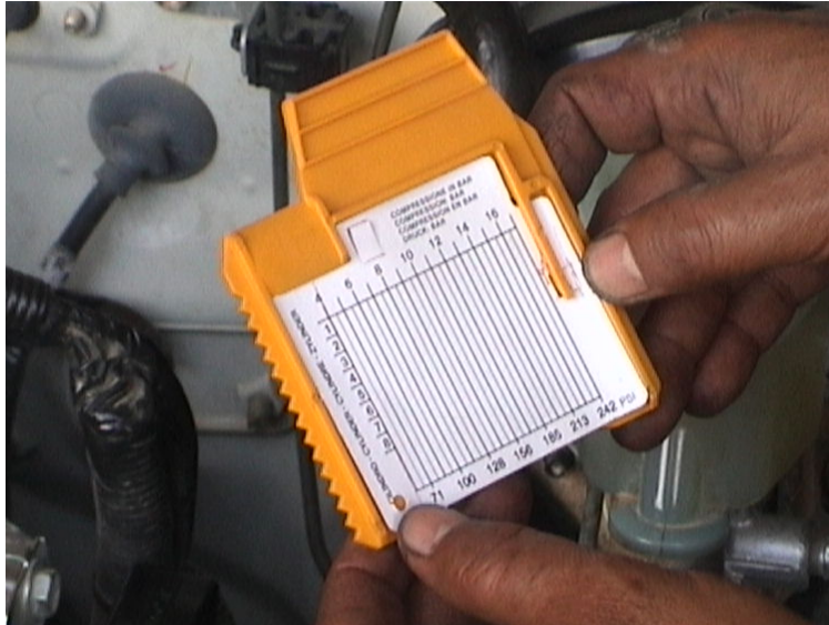
الشكل ( 2 - 4 ) يبين تركيب ورقة الفحص جديدة داخل مبيت الكارت
