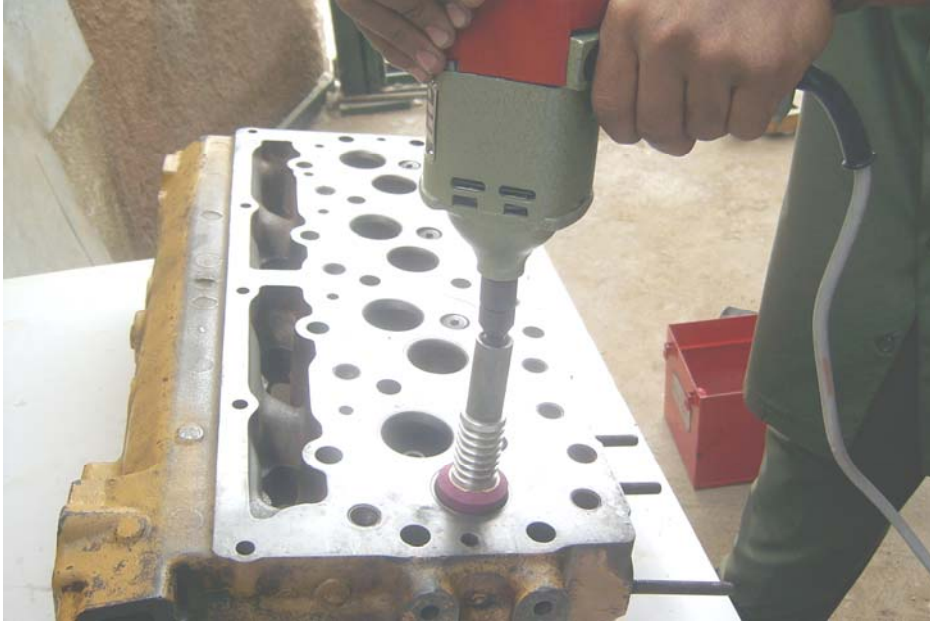
الشكل (3 - 23) يبين فرز مقعد الصمام بواسطة الدريل الكهربائي
