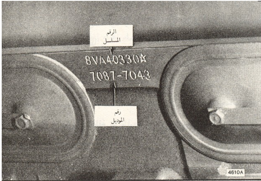
الشكل (1 - 22) يبين محرك ديزل مبين عليه الرقم التسلسلي
