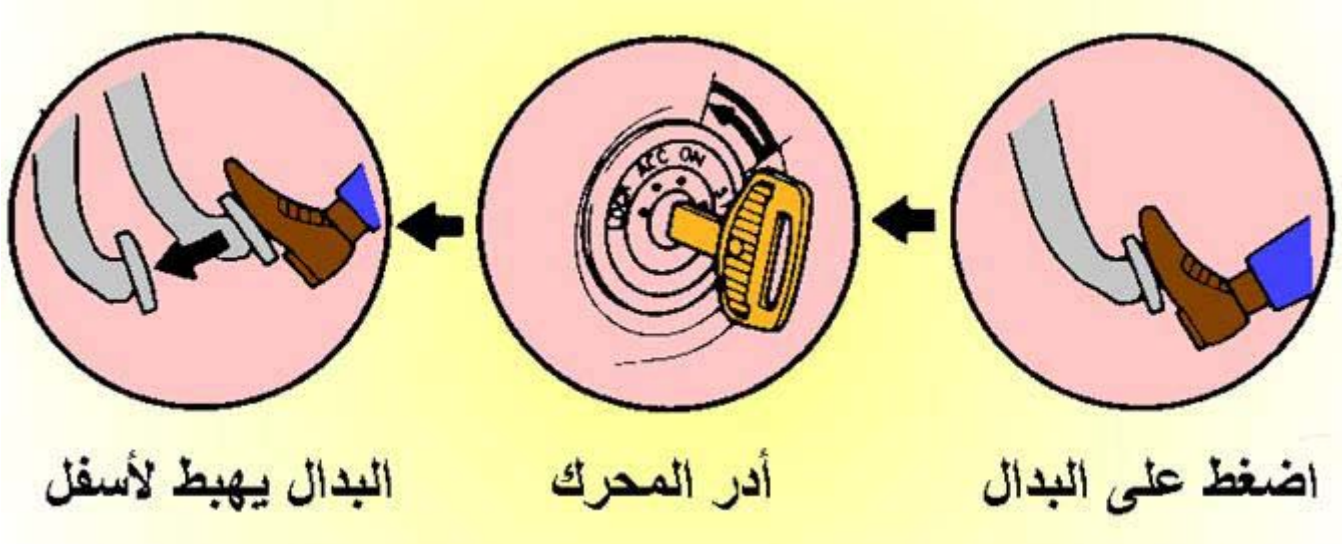
الشكل (41) يبين خطوات فحص عمل المؤازر
