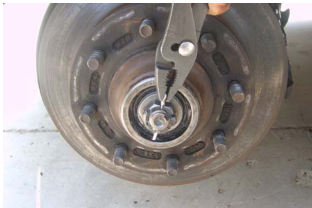
الشكل (1- 24) يبين طريقة فك تيلة الحماية بواسطة زرادية
