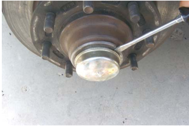
الشكل (1- 23) يبين طريقة فك غطاء مانع تسرب الشحم بواسطة المفك
