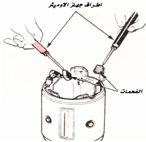
الشكل (36) يوضح اختبار الدائر المفتوحة
