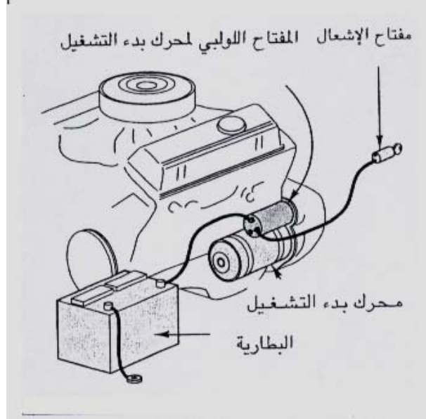
الشكل (1) يوضح أجزاء نظام بدء التشغيل
