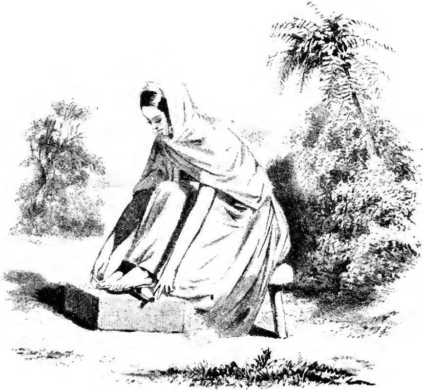
Abb. 18. Das einfachste in Indien bei den Eingeborenen übliche Verfahren der Entsamung der Rohbaumwolle mittels der Fusswalze. (Nach Forbes Royle aus Oppel.)
