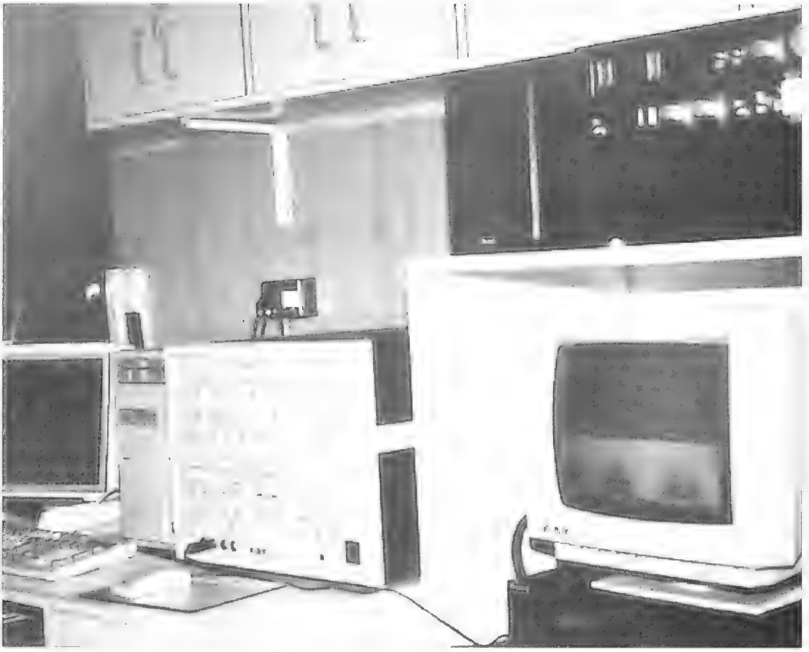
FIGURA 18. Equipo de análisis acústico Sonograph 5500.
