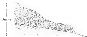
Fig. 6. Stirnrand der Ueberschiebungsdecke von Gneiss im Meolathale, in ein Trümmerwerk aufgelöst. Unterlage Mergel und Sandstein des Buntsandsteines.
