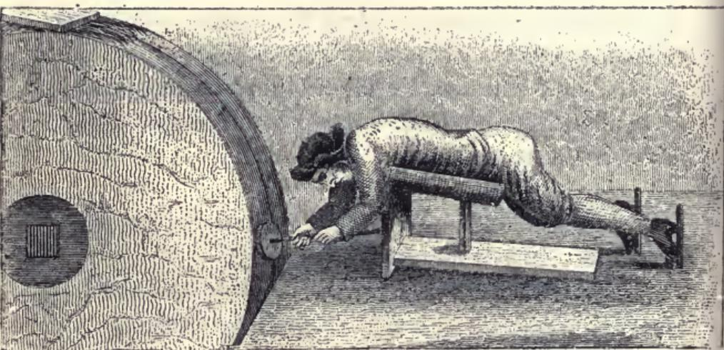
FIG. 59. — Polissage des ngates et des jaspes à la meule.
