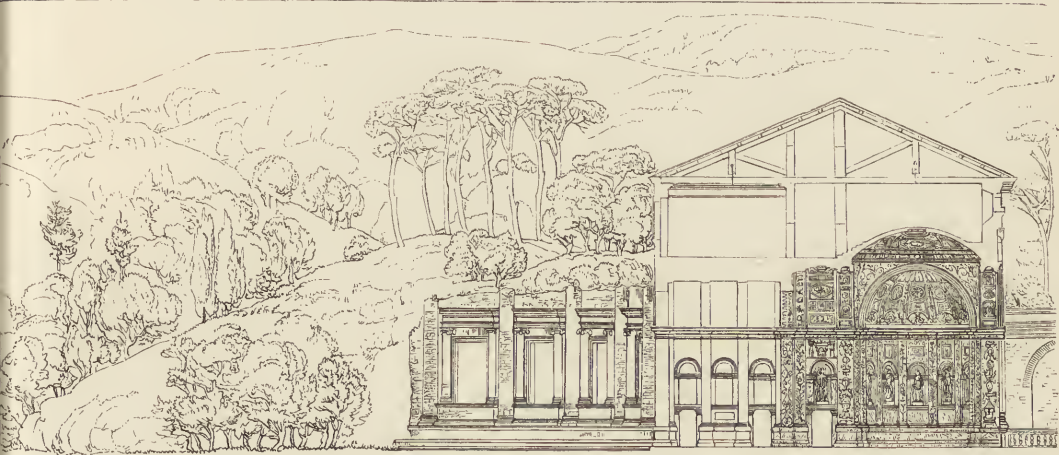
Fig. 201. Villa Madama zu Rom; Durchschnitt des Gebäudes und des halbrunden hintern Hofes.
