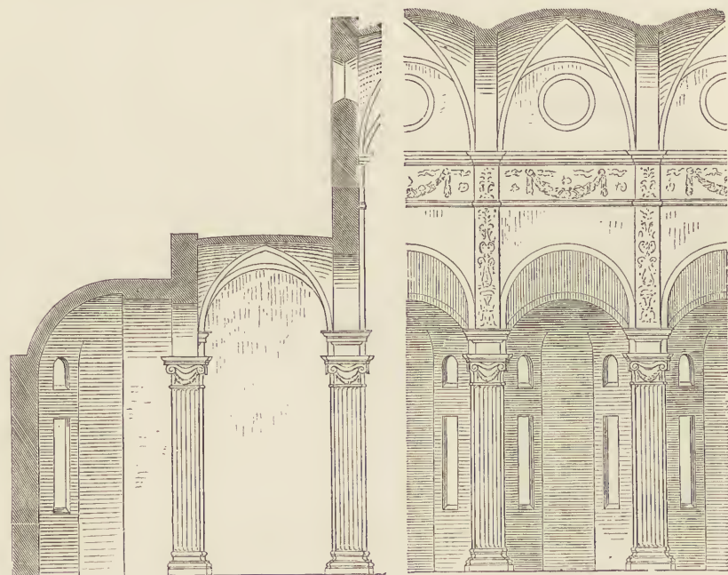
Fig. 132. S. Giovanni in Parma. Quer- und Längenschnitt. (L.)
