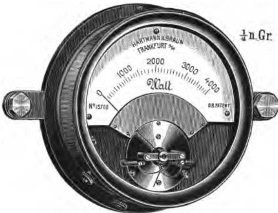
Fig. 222. Wattzeiger von Hartmann & Braun.
