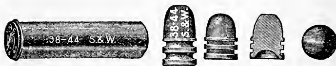
FIG. 30. — Powder, 20 gr.; bullet, 146 gr.; exact cal., 0.360. 146 gr. 110 gr. 100 gr. 72 gr.
