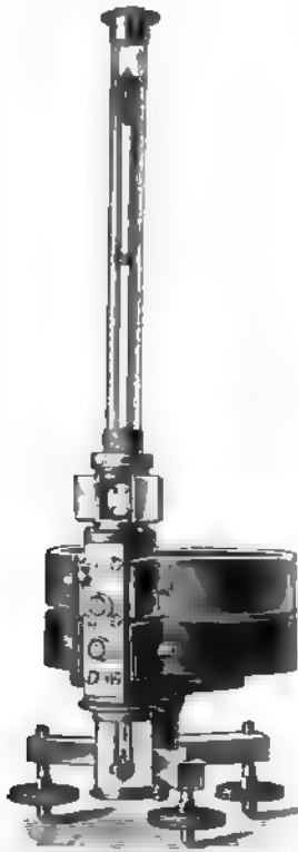
Fig 85. Spiegelgalvanometer nach Deprez-d'Arsonval von Gaus und Goldschmidt-Berlin.
