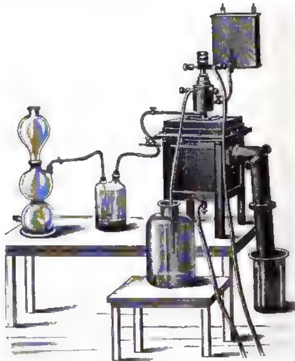
Fig. 181. Elektrischer Destillierofen der „Deutschen Gold- und Silberscheideanstalt“ in Frankfurt a. M.
