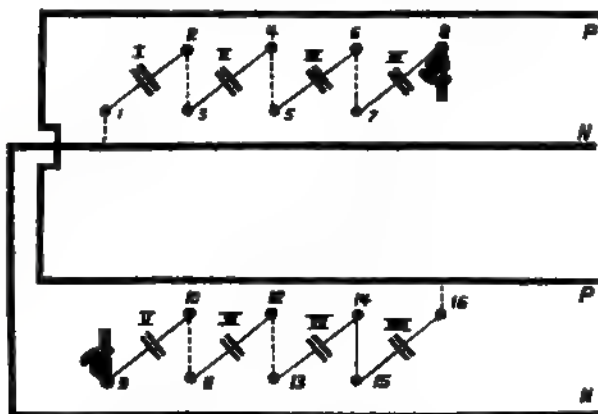
Fig. 164 Anordnung der Schalter in zwei Reihen.
