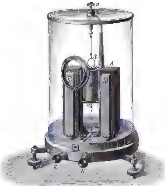
Fig. 84. Spiegelgalvanometer nach Deprez-d'Arsonval
