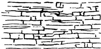
Abb. 16. Schema der Sprungbildung auf Holzbildern.
