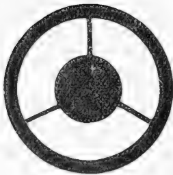
Fig. 7. Zentralblende für Dunkelfeldbeleuchtung.
