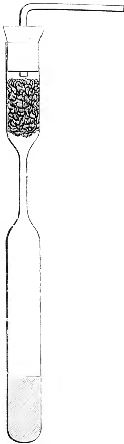
Fig. 85. GRUBER'S Röhre zur Züchtung Anaerobier. Gebrauchsfertig. — Etwas verkleinert. Nach GRUBER.
