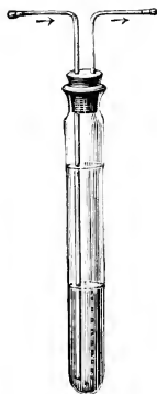
Fig. 74. Gelatine-Röhrchen für Luftuntersuchung nach HUEPPE. — Ca. ein Drittel der nat. Größe.
