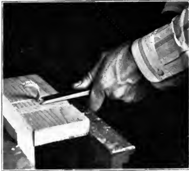
Fig. 70. Chiseling Out a Dado (First Step).
