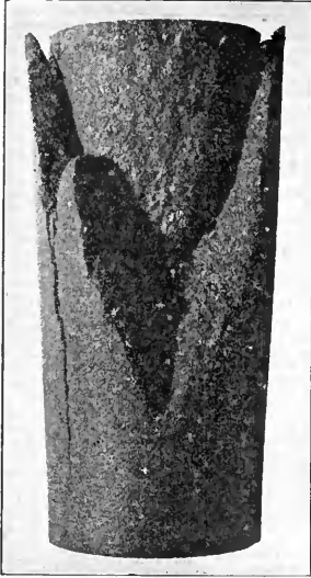
Fig. 10. Sandsteinkörper nach Druckversuch mit Kegelbildung.
