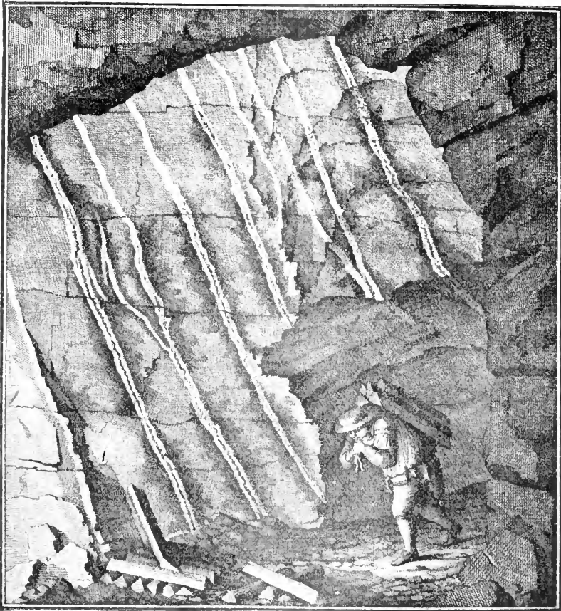
Fig. 13. Ein „Zug“ von Zinnerzgängen in Granit. Neben den Gängen ist der Granit mit Erz imprägniert. Zinnerzlagerstätten zu Geyer im Erzgebirge. Nach Charpentier.
