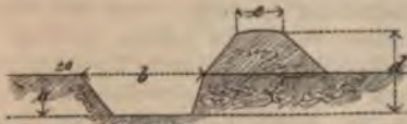
Fig. 2. Für kniende Schützen (aus Fig. 1 durch Erweiterung herzustellen). a 2 Spatenblatthöhen; b 3 Spatenlängen; c 1 Spatenlänge; d Anschlaghöhe im Liegen.
