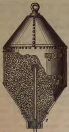
Fig. 5. Amerik. elekt. Mine aus \frac{3}{4} \"igem Eisenblech, ab Bolzen für Kettenbefestigung; p Pulverladung; z Zündsatz; s Stopfbüchse.
