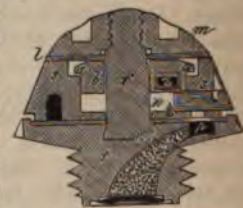
Fig. 1. Richter'scher Zeitzünder, senkrechter Durchschnitt durch die Achse und Tempirmarke.
