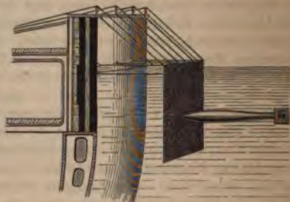
Fig. 6. Drahtnetz, als Schutzmittel gegen Whitehead-Torpedos.
