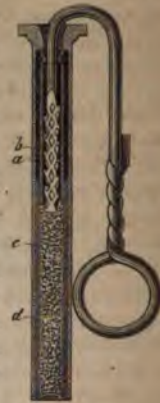
Dtsche Schlagröhre C/76. a Reiber; b Zündhülse; c Schutzhülse; d Pulverladung.
