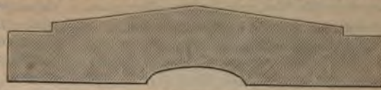
Durchschnitt nach ab, natürliche Grösse (70 mm.). Die Rinne an der unteren Fläche befördert die sichere Richtung beim Laufen auf losem Schnee.
