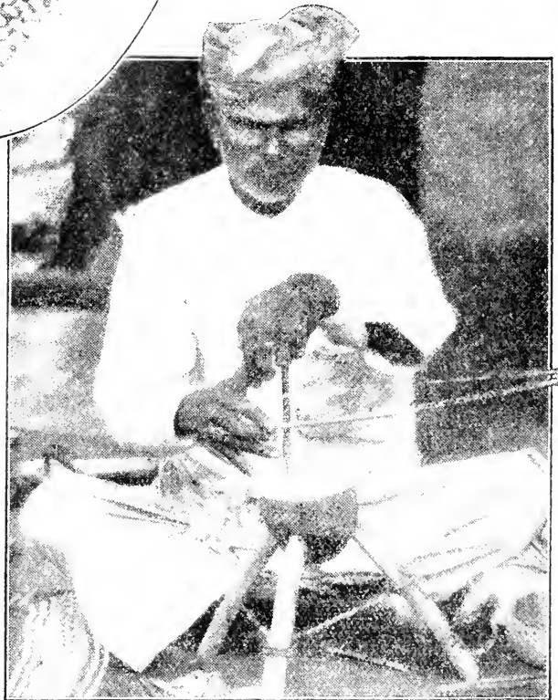
Ein Perlendurchbohrt: Mit dem Bohrrapparat durchbohrt er 300—600 Perlen an einem Tag.
