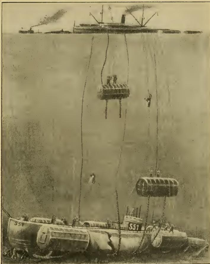
2. Der zweite Versuch, das gesunkene Boot zu heben: Man senkte Pontons in die Tiefe und verkettete sie unter dem Boot. Leergepumpt sollten sie wie Luftballons das Boot emporziehen.
