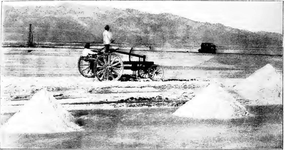
Salzgewinnung in Kalifornien: Das Steinsalz wird durch Wasser aufgelöst und als Sole aus dem Erdinnern gepumpt. Das Wasser wird verdampft und das Salz zu Haufen geschaufelt.
