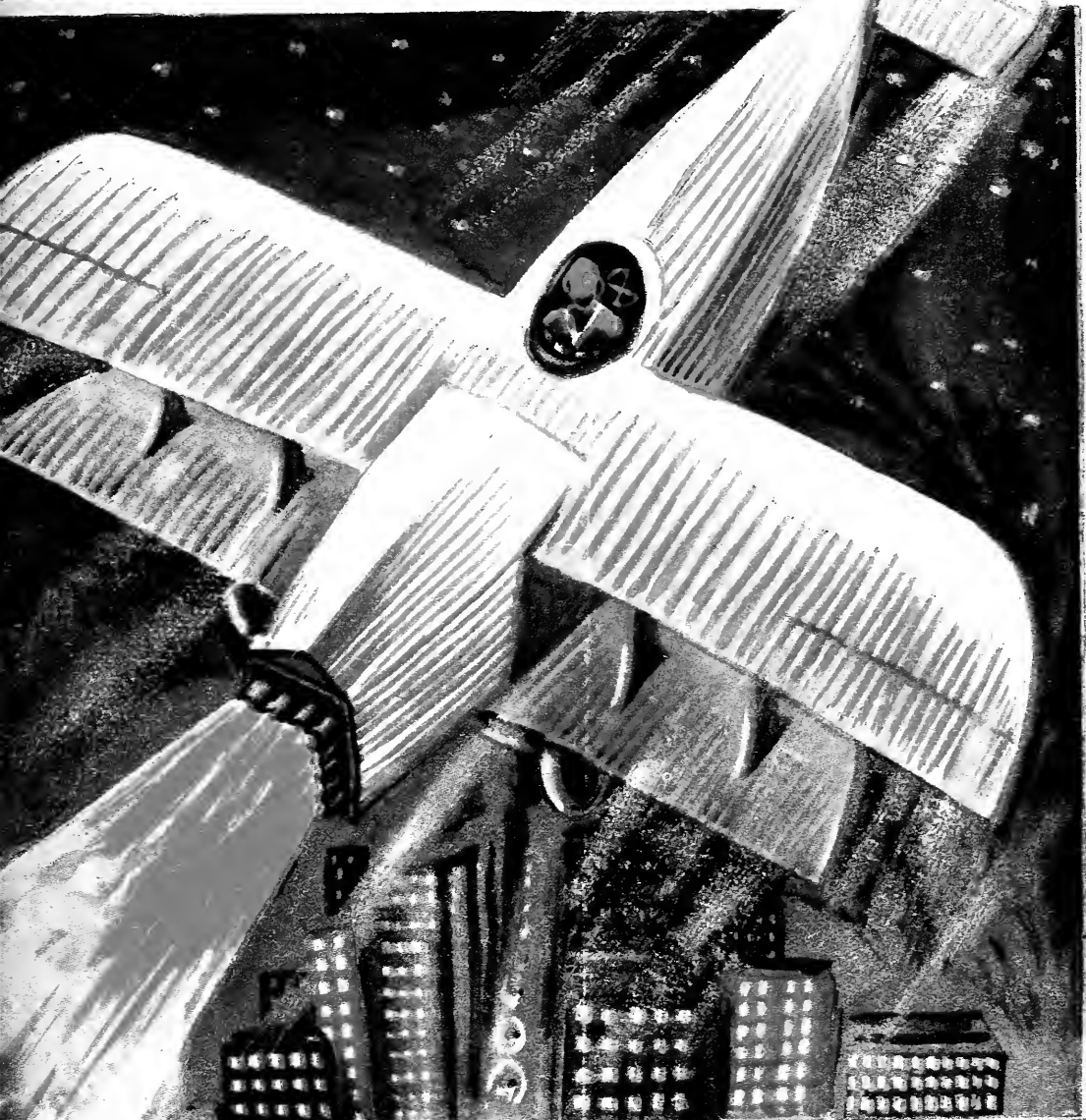
Das Raketenflugzeug der Zukunft: Bei dem Raketenflugzeug ist alles umgekehrt wie bei den Propellerflugzeugen: die Steuerflächen befinden sich vorn, die Tragflächen und der Raketenantrieb liegen hinten. (Zu dem Artikel S. 2-3.)
