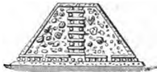
Fig. 122. — Grillage du minerai en tas.
