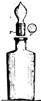
Fig. 58. — Flacon avec bouchon creusé à la lime d'une simple rainure r.
