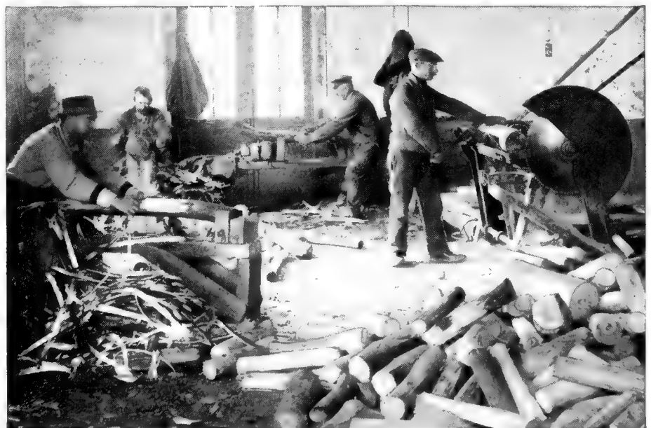
Écorçage et sciage du bois pour la fabrication du papier.
