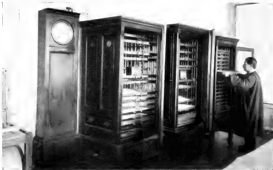
Étuves Schribaux pour l'étude du pouvoir germinatif des graines.
