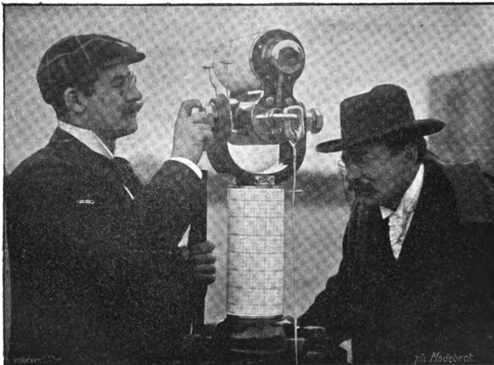
Fig. 4. Der Anemo-Dynamograph des meteorologischen Drachenballons.
