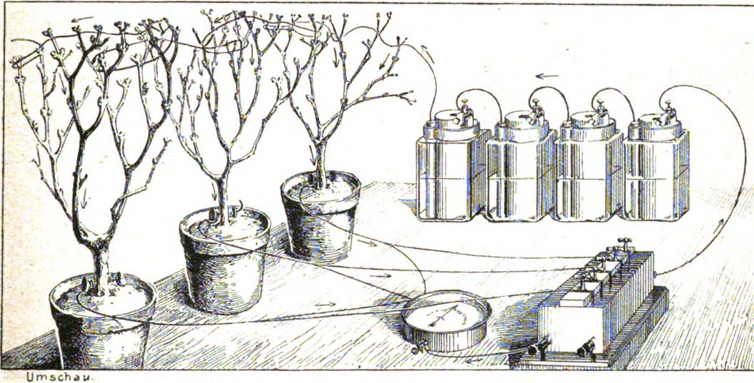
ander mit verschiedenen Gipfelenden der Zweige verbunden. Für die Befestigung des Drahtes an den Zweigenden erwies es sich als vorteilhaft, ihn nicht unmittelbar durch ein kleines Loch am Zweige zu ziehen, sondern Nähnadeln von Stahl in die Zweigenden gerade zwischen die beiden Endknospen zu stecken und durch deren Ohr den Messingdraht zu ziehen.
