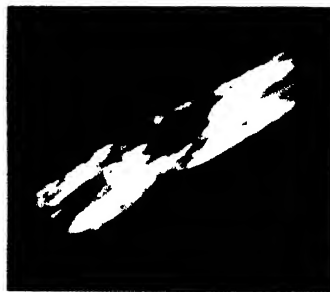
Abb. 8. Zackige Ausbrechung und rhombische Korrosionsfiguren eines Trümmerstückes einer Cellulosefaser. Vergr. 750mal. Aufnahmedaten vgl. S. 259.
