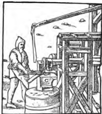
Fig. 6. Schwanzhammer mit Wasserbetrieb. Nur der vordere Teil sichtbar.
