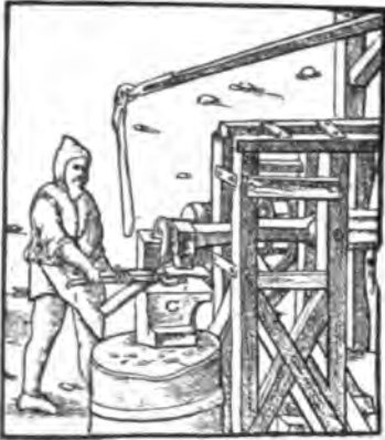
Fig. 6. Schwanzhammer mit Wasserbetrieb. Nur der vordere Teil sichtbar.
