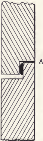
FIG. 28.—Joint in split crucible mould.
