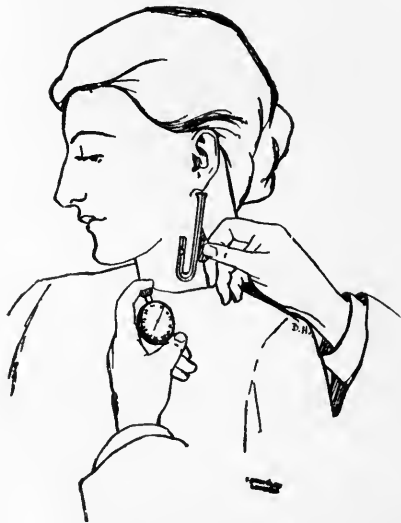
FIG. 82.—Denning-Watson Clinical Viscosimeter ( Hawksley ).
