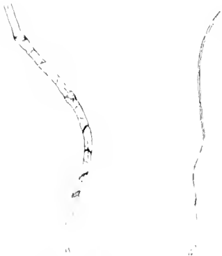
Abb. 234. Mittelstück (a) und Endstück (b) von Fasern des Gewebes mit Kupferrostfärbung aus Tum. III: typische Leinfaser.
