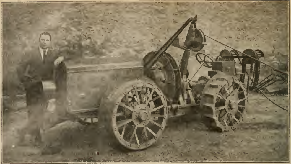
Fig. 77. — Treuil Estrade, de la Société d'électro-motoculture, disposé pour le transport sur route (type 1922).
