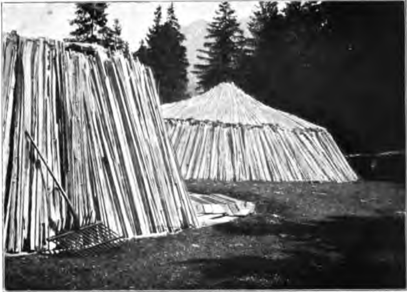
(Nach Phot. von S. Dopfer.) Kohlenmeiler vor der Verkohlung.
