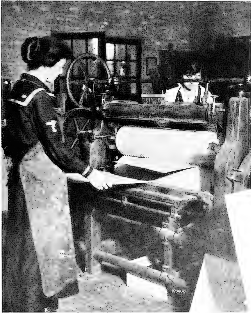
No fabricio das madeiras folheadas com colla de caseina, a gomma é collocada a frio sobre os folheados por meio de um aparelho mechanico de distribuir colla. As folhas são depois collocadas uma sobre a outra na prensa.
