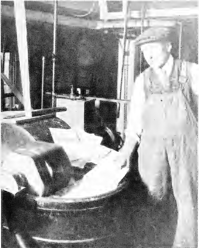
Papeis velhos de jornal podem ser separados da tinta pelo uso da ventonite, uma argila altamente colloidal, á qual as particulas da tinta adherem depois de serem desagregadas do papel numa machina de fazer pasta de papel. A pasta de papel fica outra vez em condições de ser usada no fabrico de papel de jornal.
