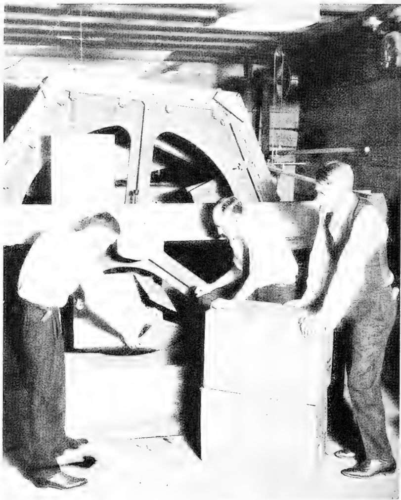
A machina de ensaios em forma de tambor, feita pelo laboratorio para simular os choques dos transportes, e que se tornou uma machina padr o para carregadores, embaladores e fabricantes. As caixa sest o cheias de lampadas de luz electrica. As companhias de electricidade deram quatro mil dollars de lampadas para se poderem effectuar as experiencias destinadas a preparar um melhor recipiente.
