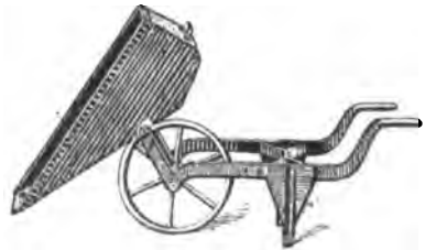
Fig. 85. — Brouette en fer à caisse basculante.
