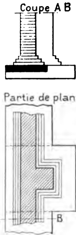
Fig. 174. — Semelle sous mur avec dossierets.
