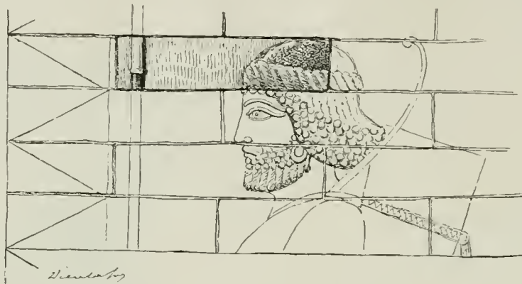
FIG. 156. — MONTAGE DE LA FRISE DES ARCHERS. BRIQUE DE JONCTION DU CRANE ET DE LA DOUILLE DU FER DE LA JAVELINE.
