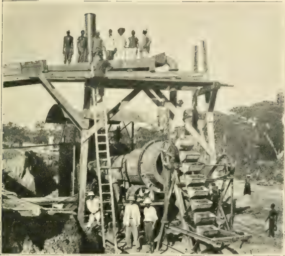
AUX MINES D'OR DE SIGUIRI (HAUTE-GUINÉE). LE TROMMEL OU APPAREIL DE TRIAGE. — CLICHE MARIÉ.
