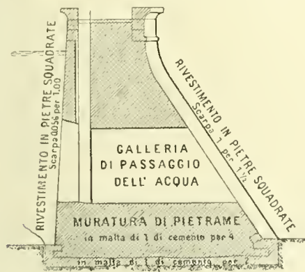
Sezione trasversale della diga.
