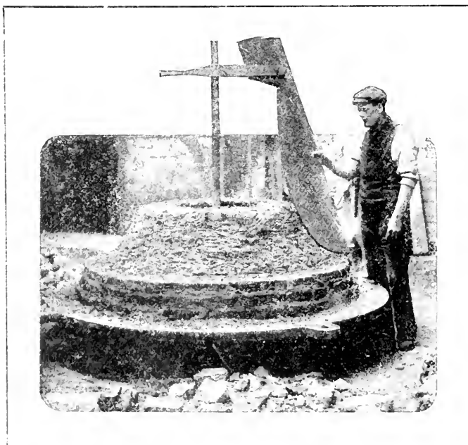
Formazione della parete interna del modello di una campana per mezzo della tavola girante.
