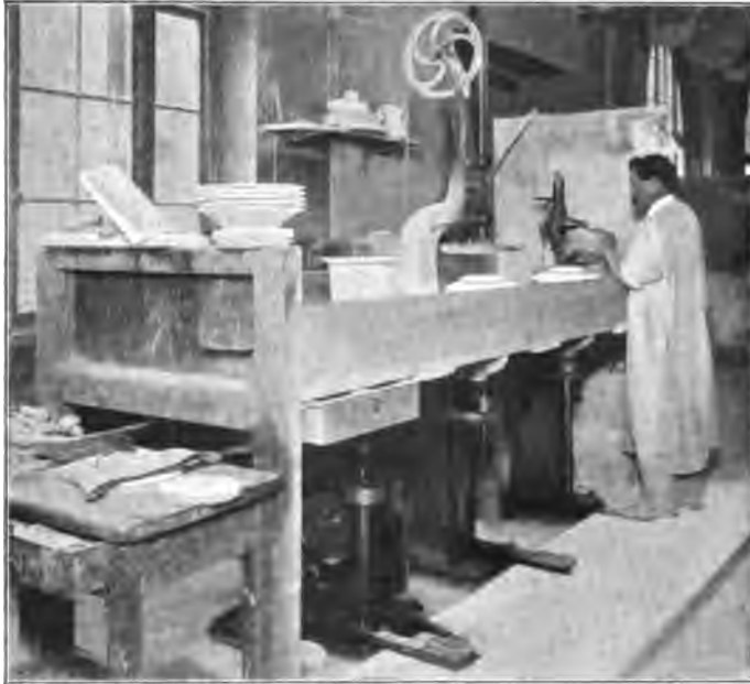
Grand atelier de fabrication. — Le façonnage des assiettes.
